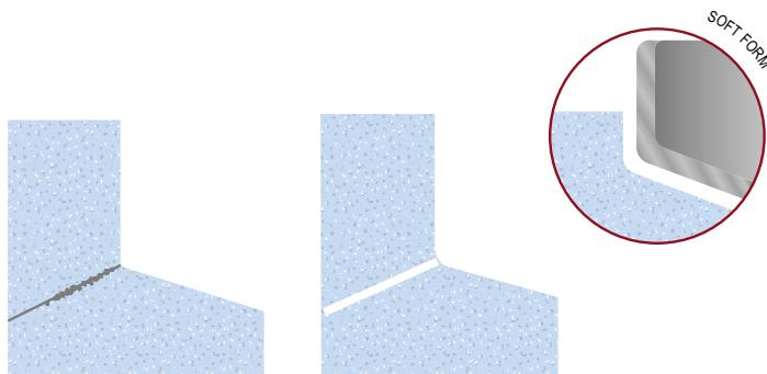
Die einzigartige Soft-Form-Schneidkante an den Fräsern für Mineralwerkstoffe verhindert die Entstehung von Spannungsrissen.
