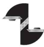
gelötete Bohrschneide bei D18-D25
