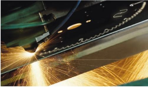
Titman Präzisions-Sägeblätter werden mit Hartmetall Zähnen auf Feinkorn-Basis hergestellt. Eine große Bestückungshöhe der Sägezähne gewährleistet eine lange Nutzungsdauer und somit Kostenersparnis. Durch die Fertigung auf modernsten CNC-gesteuerte Automaten bieten wir eine gleichbleibend hohe Qualität bei geringsten Fertigungstoleranzen für saubere Schnitte und Oberflächen.
